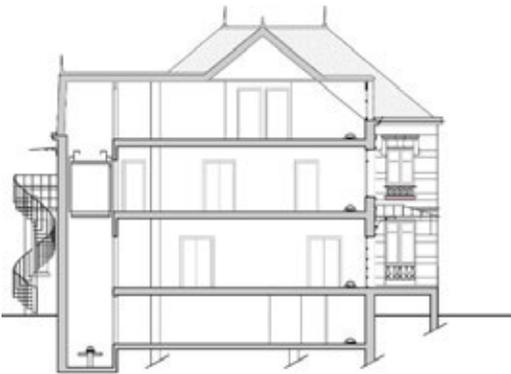
Sur le plan du Rez-de-chaussée ci-dessous, parmi les coupes mentionnées ci-dessous (aa, bb, cc et dd), quelle est celle représentée ci-dessus ?
